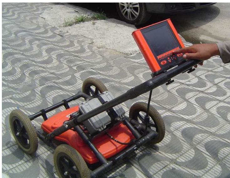
Figura 1 - Detalhe do equipamento Geo-Radar ou GPR
