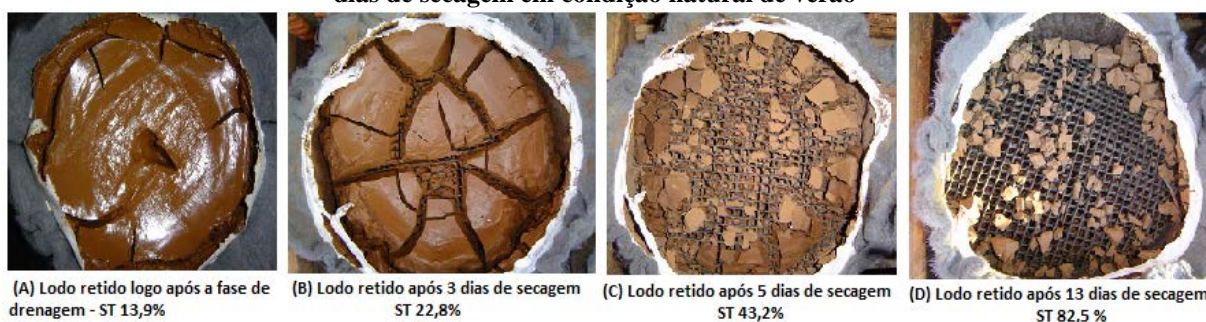
Figura 3: Fotos da torta de lodo tipo B retida na manta logo após a fase de drenagem e após 3, 5 e 13 dias de secagem em condição natural de verão
