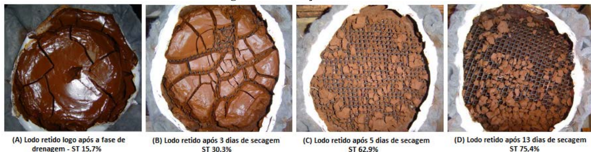
Figura 2 :Fotos da torta de lodo tipo A retida na manta logo após a fase de drenagem e após 3, 5 e 13 dias de secagem em condição natural de verão
