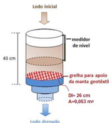
Figura 1: Esquema da unidade de desaguamento em escala reduzida
