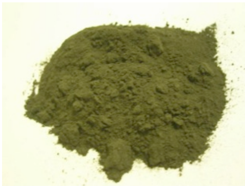
Figura 1: Lodo de ETA utilizado na coluna laboratorial após moagem.
