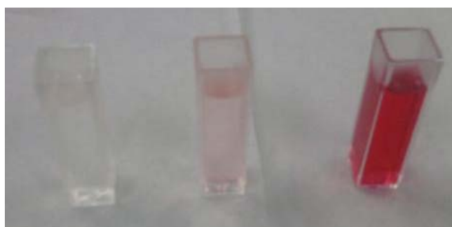
Figura 3: Degradação obtida para o tempo de 180 minutos sob luz solar, para a concentração de 20 mg/L do sistema \text{Fe}/\text{H}_2\text{O}_2 (cubeta da esquerda), da LVN/ \text{H}_2\text{O}_2 (cubeta do meio) e o corante sem tratamento (cubeta da direita).
