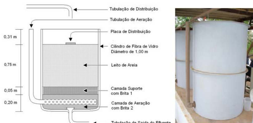
Figura 3 – Esquema geral dos filtros de areia e uma vista lateral do filtro de areia.
