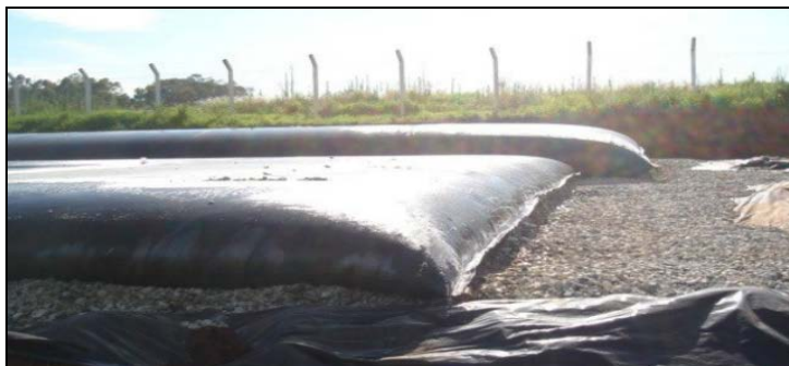
Figura 1 - Desaguamento de lodo removido da ETE do município de Coronel Macedo-SP em BAGs
