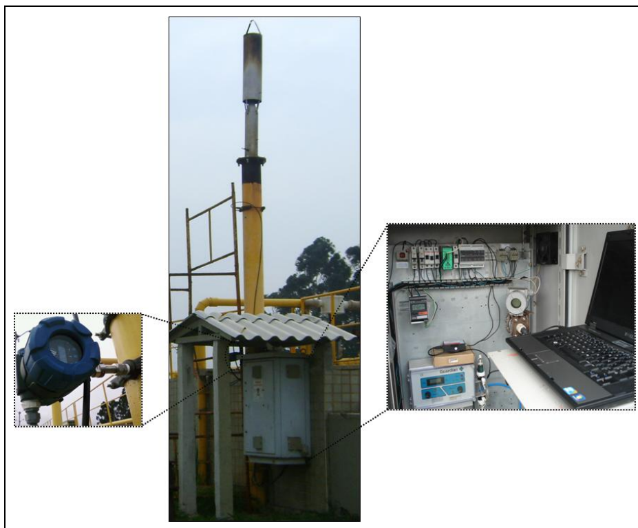
Figura 1: Foto do arranjo experimental utilizado para medir em tempo real e em condições de guaiamento passivo os seguintes parâmetros inerentes ao biogás: vazão, teor de metano, temperatura e pressão manométrica. Em destaque são apresentadas as fotos do transmissor de temperatura e vazão de biogás, além de uma foto do interior do quadro de comandos.
