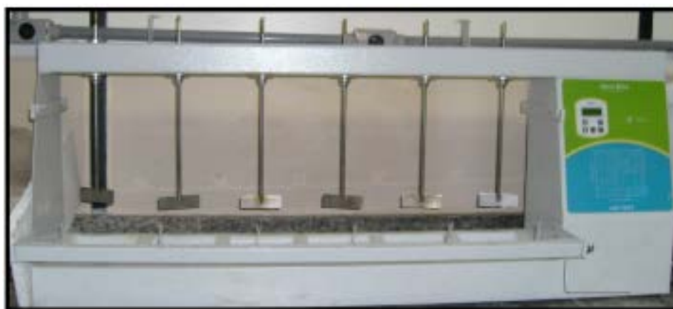
Figura 3 – “Jar Test” utilizado nos ensaios.
