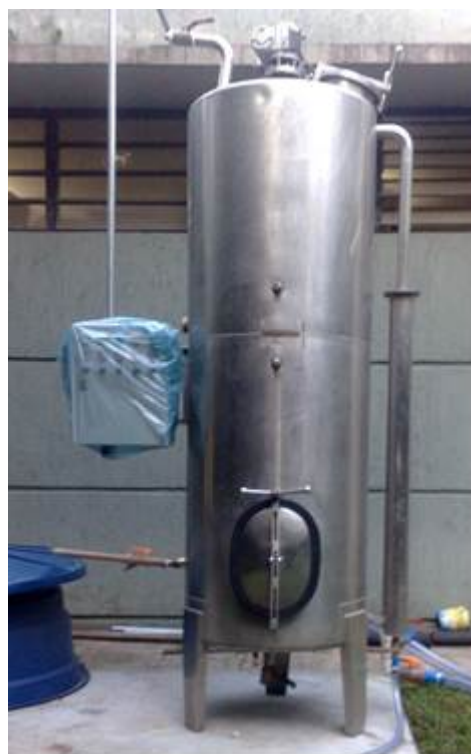
Figura 1 - Desenho e foto do biodigestor projetado e construído.
