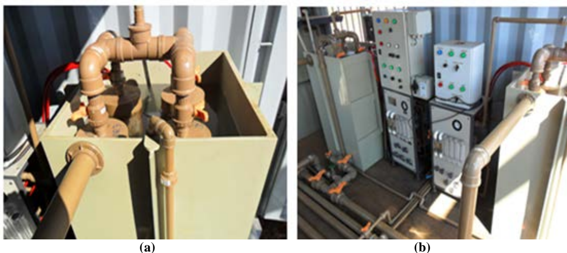
Figura 1: (a) Módulos de microfiltração submersos instalados dentro do tanque. (b) Unidade piloto de microfiltração submersa, bem como suas interligações.
