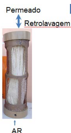
Figura 2: Representação do módulo de microfiltração submersa.
