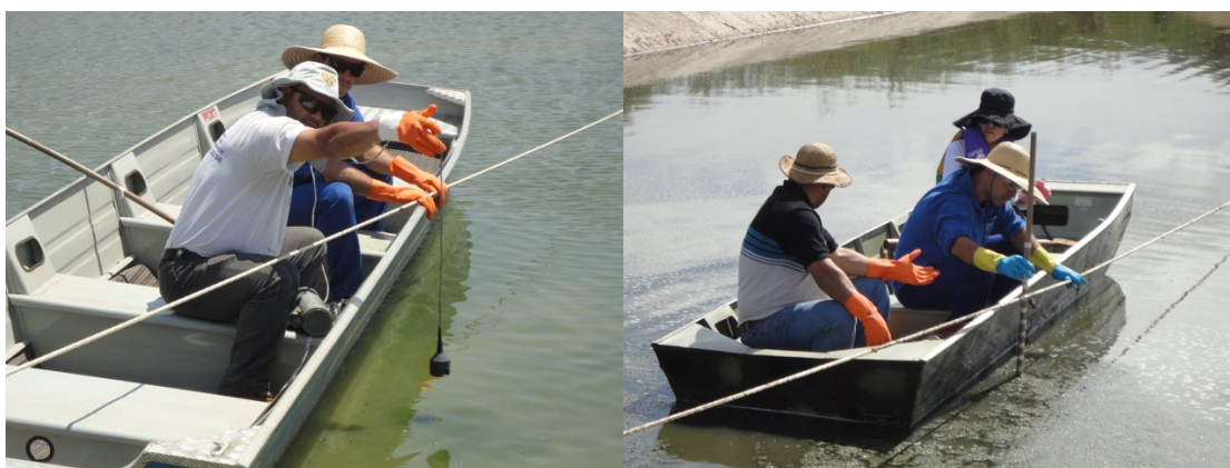
Figura 4: Operação de medição das alturas de lodo.
