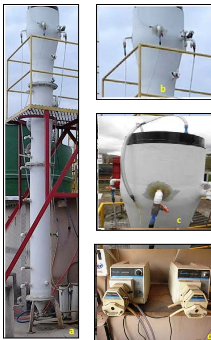
Figura 1. Stripping na zona de decantação. a-R3; b-pontos de distribuição da vazão de ar; c-ponto de coleta do gás \text{CH}_4 ; d- bombas de ar.
