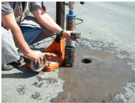
Figura 4. Sonda rotativa para extração dos corpos de prova do trecho experimental em Extrema - MG.
