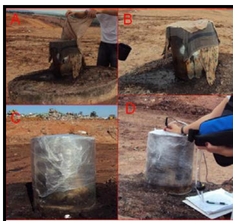
Figura 1: Procedimentos para medição da concentração do biogás.
