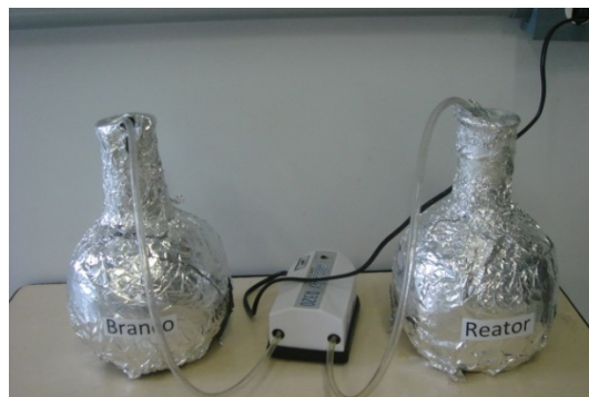
Figura 3: Ensaio de biodegradabilidade aeróbia – recipientes envoltos por alumínio para evitar contato com a luz.
