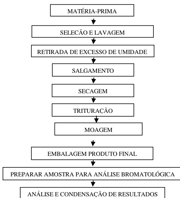
Figura 1: Descrição das etapas para produção de concentrado de proteína bruta (farinha de resíduos de peixe).
