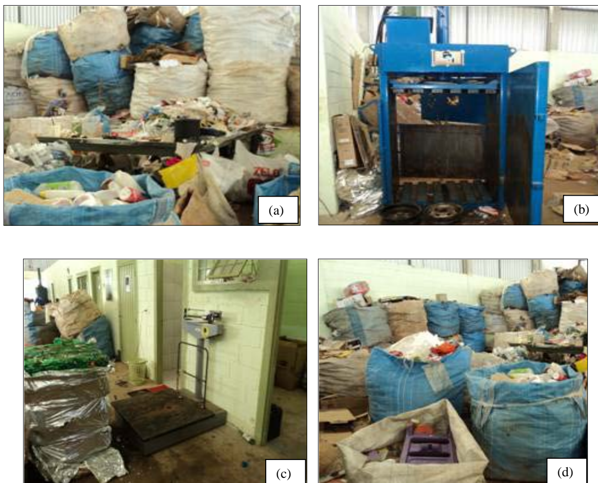
Figura 4: Equipamentos utilizados para a catação dos recicláveis na Central de Triagem: (a) mesa separadora; (b) prensa enfardadeira; (c) balança; (d) big bag's para acondicionamento dos materiais.
