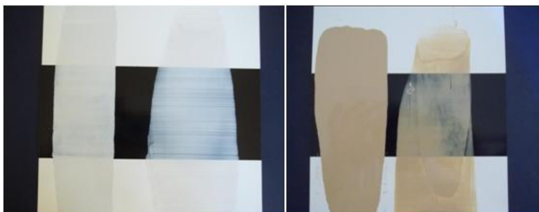
Figura 5: Diferença do poder de cobertura das tintas de alto e baixo teor de sólidos nas cores branca e imbuia.
