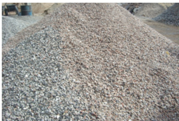
Figura 16: Brita reciclada produzida na USIFORT
