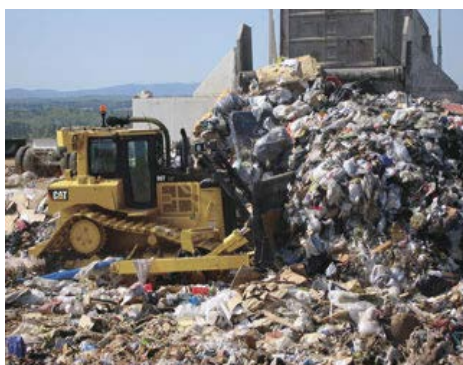
Figura 1 - Compactação de resíduos com trator de esteiras
