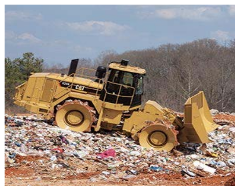
Figura 2 - Compactação de resíduos sem trator de esteiras
