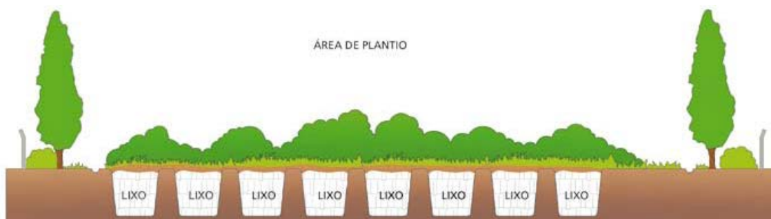
Figura 5: Perfil e corte esquemático do aterro em valas finalizado. Fonte: CETESB, 2010
