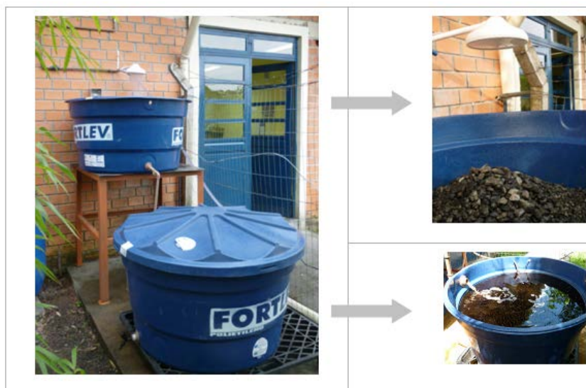
Figura 2: Planta piloto para biolixiviação da pirita no Campus da UFRGS.
