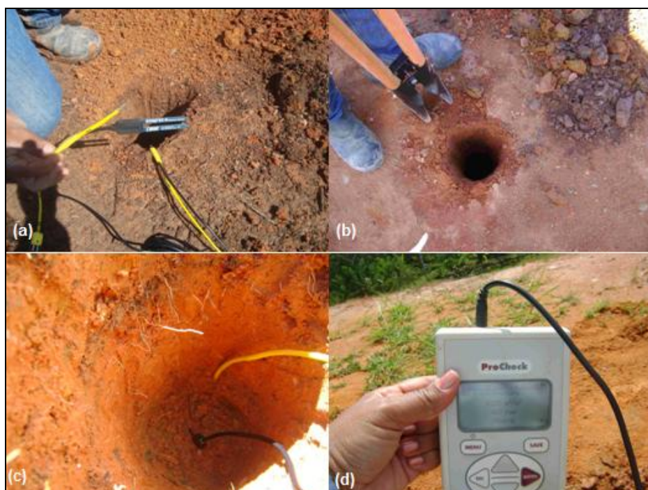
Figura 2: Instalação de sensores para medição de umidade (a) sensor EC5 (b) escavação para instalação (c) Inserção do sensor no solo (d) medição com leitora ProCheck.
