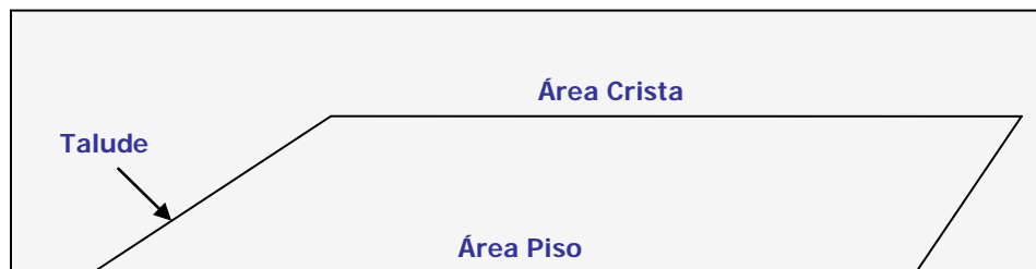
Figura 3 – Representação Esquemática da Célula do Aterro.
