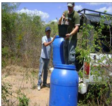
Figura 5 - Tambores com água (200 L) utilizados nos testes de infiltração.
