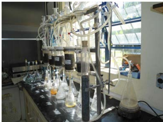
Figura 2: Foto das células úmidas para realização dos ensaios cinéticos.
