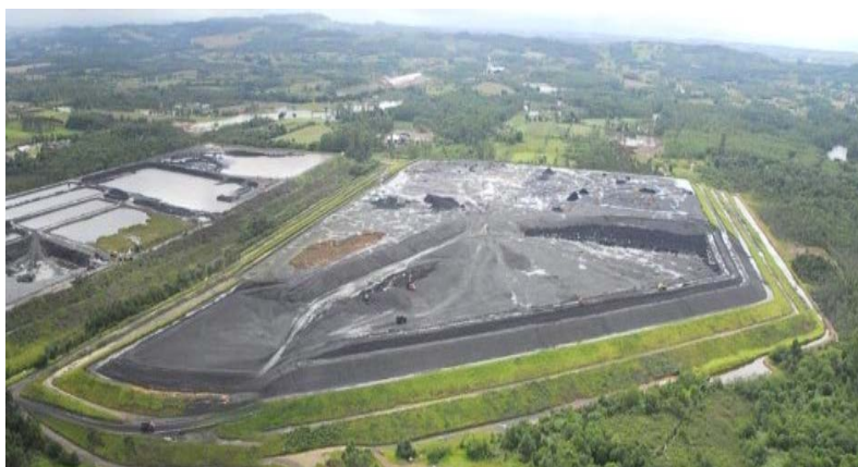
Figura 1: Vista superior do módulo B de rejeitos da Carbonífera Criciúma S.A, com aproximadamente 13 milhões de toneladas de rejeitos de carvão.
