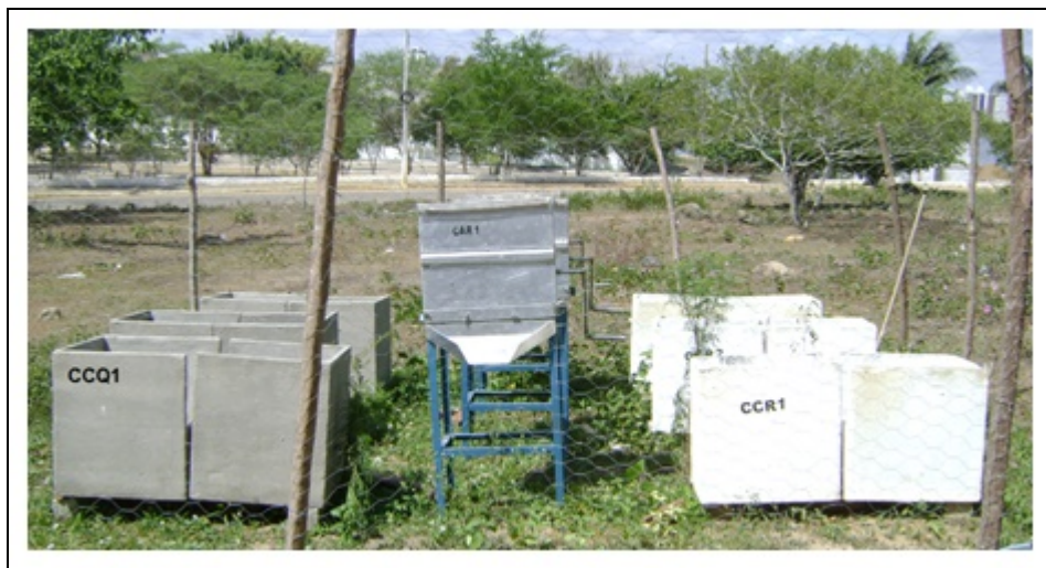
Figura 7. Composteiras confeccionadas em concreto com configuração em retângulo (CCR) e com configuração em quadrado (CCQ), e de composteiras confeccionadas em alumínio e aço inoxidável com configuração em retângulo (CAR), instaladas nas dependências físicas do complexo integrado de pesquisa Três Marias (UEPB), Campina Grande-PB, 2015
