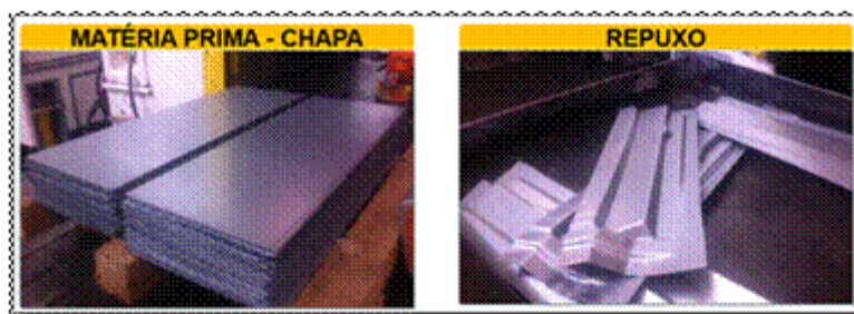
Figura 3 - Estampagem de peças: Deformação
