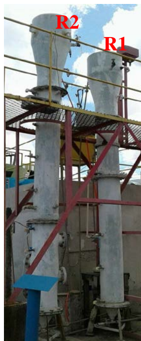
Figura 1: Representação real dos reatores - controle (R1) e microaerado (R2).
