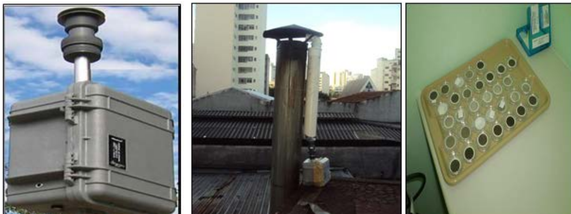
Figura 1: Amostrador MiniVol, duto acoplado à chaminé e filtros amostrados em sala de pesagem.
