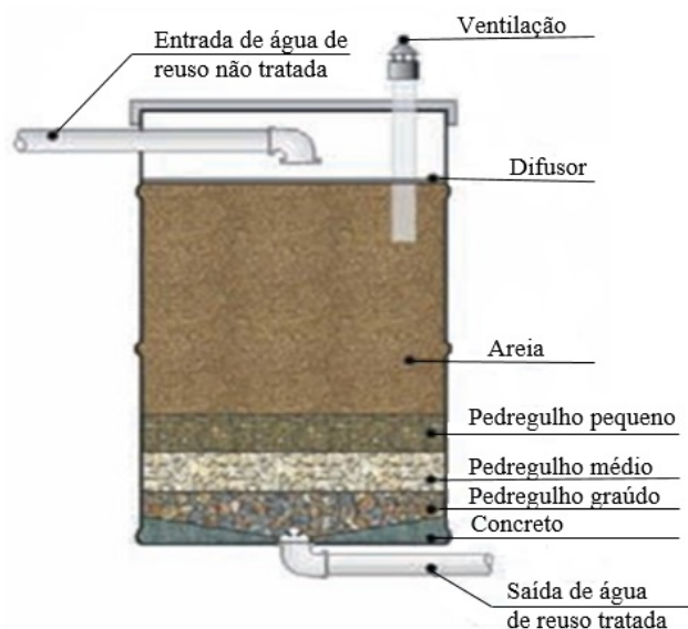
Figura 2: Filtro de múltiplas camadas utilizados para o tratamento de águas cinza destinadas ao reúso. Fonte: Oliveira et al. , 2007.
