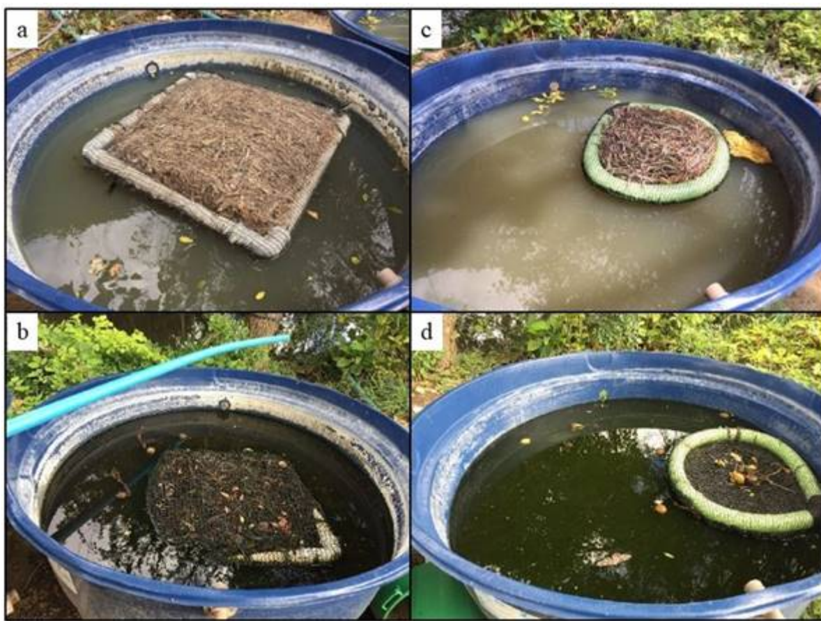
Figura 3: a) e b) Ilha flutuante de PVC com bagaço de cana de açúcar nos dias 09/12/2016 e 20/03/2017; c) e d) Ilha flutuante de esponja com vagem de feijão nos dias 09/12/2016 e 20/03/2017.
