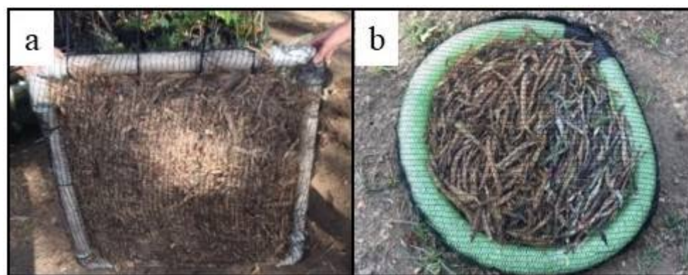
Figura 2: a) Estrutura de PVC com bagaço de cana de açúcar; b) Estrutura de esponja com vagem de feijão
