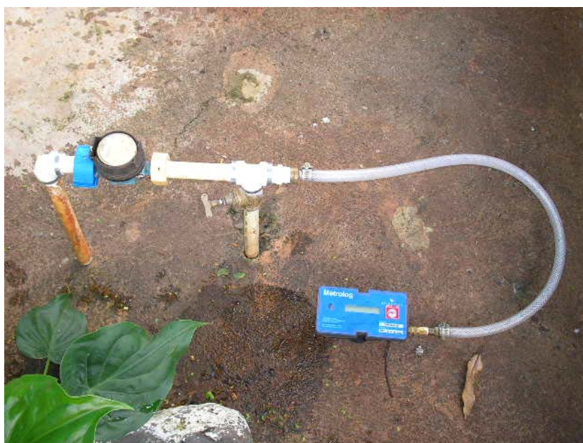
Figura 1: Datalogger da Metrolog instalado em cavalete de residencial para medição da pressão.
