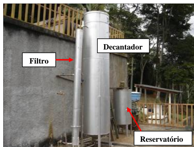
Figura 3: Vista parcial da ETA piloto, decantador, filtro e reservatório de inoculação de cianobactérias.
