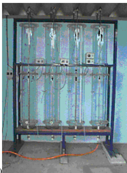
Figura 2 – Colunas de sedimentação que foram utilizadas nos ensaios de sedimentação. (A) Fotografia ilustrando as colunas de sedimentação; (B) esquema das colunas de sedimentação.
