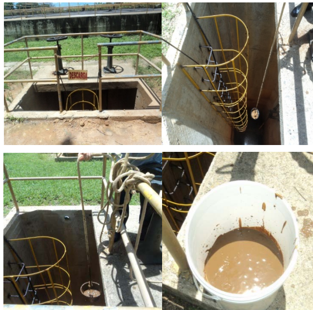
Figura 1. Fotos do procedimento de coleta de lodo da ETA Botafogo. Fonte: Do Autor (2013).
