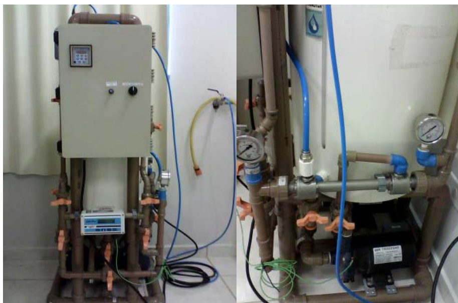
Figura 2 – Sistema piloto de microfiltração utilizado no trabalho.
