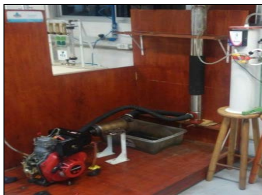
Figura 1: Sistema utilizado para medição dos gases e coleta de amostras.
