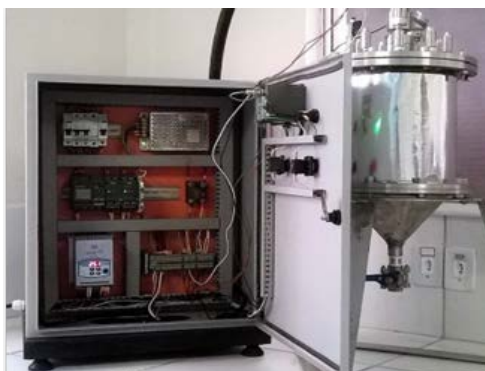
Figura 1. Reator automatizado e seu sistema de instrumentação de aquisição de dados (PONTES, 2018).
