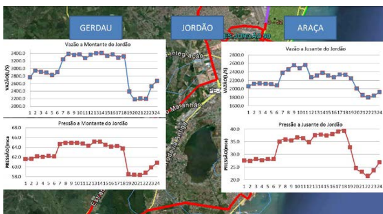
Figura 2 - Variação de Pressões e vazões a Montante e a Jusante do reservatório do Jordão
