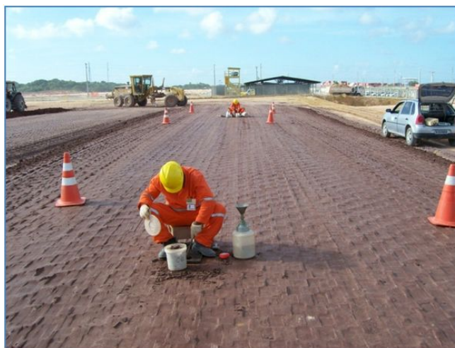
Figura 05: Realização de ensaio de densidade in situ .
