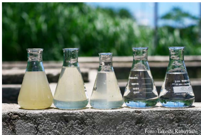
Figura 6: Aspecto visual do esgoto ao longo do tratamento nos filtros biológicos
