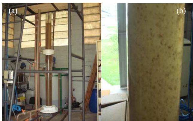
Figura 2: (a) reator RBSG; (b) detalhe da formação dos grânulos aeróbios no seu interior.
