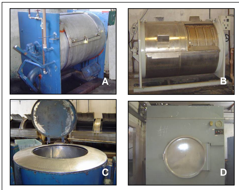
Figura 2: A - Lavadora piloto; B - lavadora industrial; C - centrífuga industrial e D - secadora industrial.
