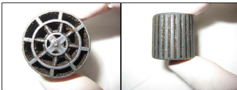
Figura 4: Biomassa aderida ao Meio suporte utilizado
