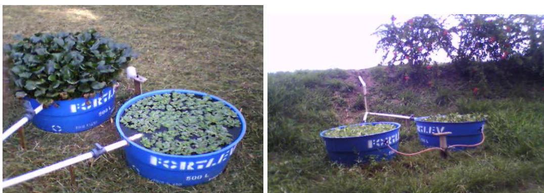
Figura 2: Sistema simplificado de tratamento terciário de esgotos com macrófitas aquáticas em operação – projeto piloto montado na ETE Camburi/Vitória-ES
