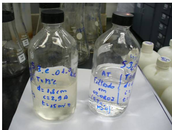
Figura 7: Amostra de esgoto tratado no reator eletrolítico A (d=1,8 cm), com eletrodos de desgaste Fe, em T=13 °C, com tempo de retenção de 15 min, de decantação de 2 horas e amostra após filtração.
