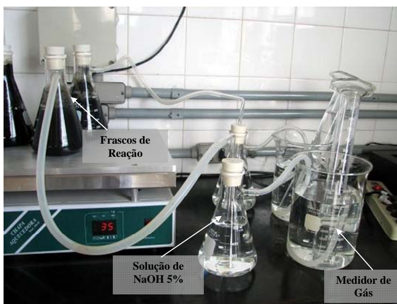
Figura 1. Aparato experimental para a realização do ensaio da AME.
