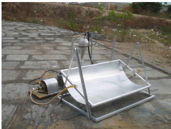
Figura 1. Reator fotocatalítico tipo calha parabólica
