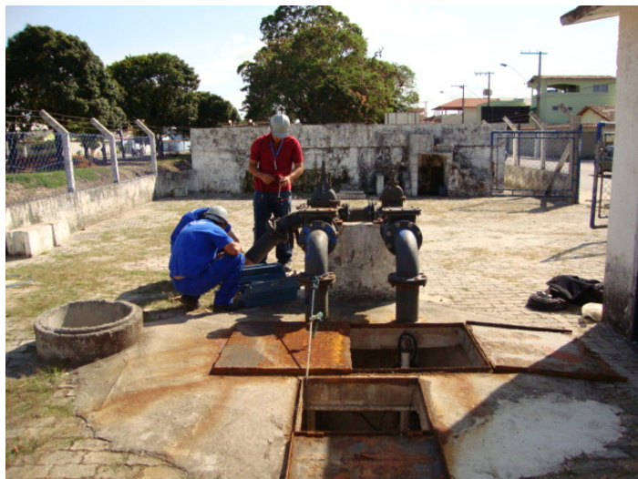
Figura 2: coleta de dados (medição de vazões).
