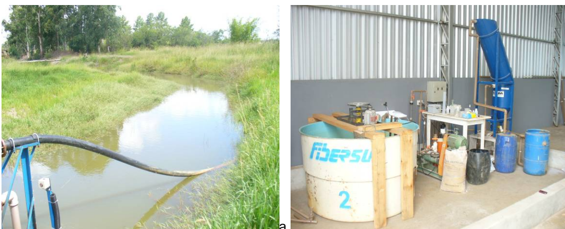
Figura 2. a) Detalhes da bacia de efluentes neutros gerados pelo despejo de água do “lavador” de carvão na Mina do Recreio e b) Unidade de tratamento por PF-Sedimentação lamelar, 1 \text{ m}^3 \cdot \text{h}^{-1} .
