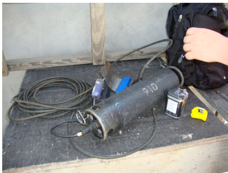
Figura 3: equipamento utilizado na medição da vazão afluente
