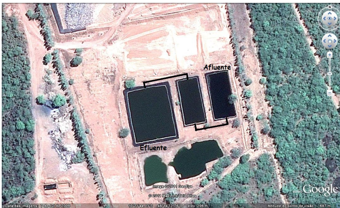
Figura 1: Sistema de tratamento de chorume utilizando lagoas de estabilização – Aterro Sanitário de Palmas-TO.
