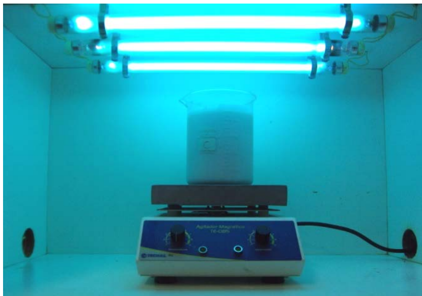
Figura 1: Reator fotocatalítico tipo tanque.
