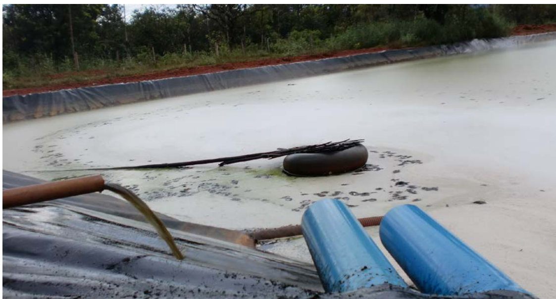
Figura 13 - Injeção do traçador e a mancha do traçador no interior da lagoa.
