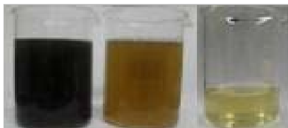
Figura 9: Aspecto visual do lixiviado bruto, após tratamento por coagulação/floculação/sedimentação e após tratamento por coagulação/floculação/sedimentação e nanofiltração
