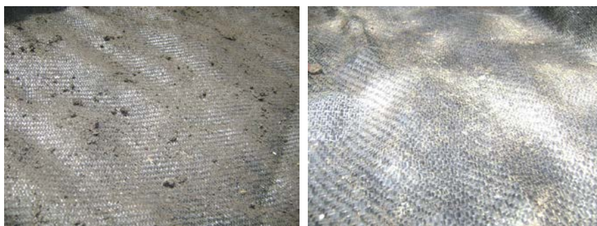
Figura 14: Aspecto da manta após a remoção manual da torta de ensaio sem condicionamento à esquerda (E9) e com condicionamento à direita (E10).
