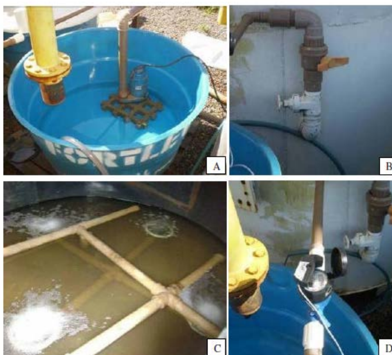
Figura 5: Aspectos do protótipo. A: Sistema de entrada; B: Registros de controle de vazão; C: Tubulação de entrada e difusores de ar; D: Medidor de vazão de entrada.
