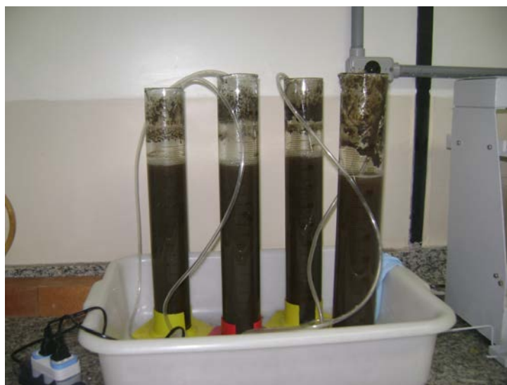
Figura 1: Reatores em batelada para ensaio de consumo de matéria orgânica.
