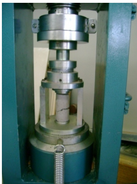
Figura 5 – Corpo-de-prova sendo rompido na prensa hidráulica, Pavitest Servi.
