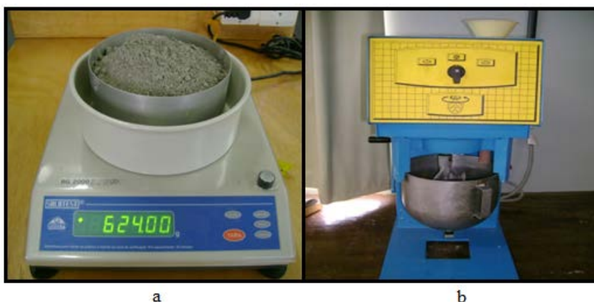
Figura 3 - (a) Balança digital, modelo BG 2000; (b) Misturador planetário, modelo E094X.
