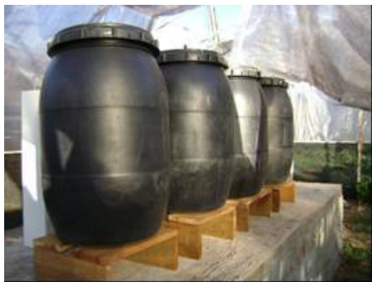
Figura 2. Bombonas de 200 L utilizado como biodigestores. (a) suporte e saída inferior para chorume. (b) saída superior para biogás.
