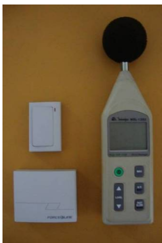
Figura 5 – Campainha sem fio utilizada como fonte sonora e o decibelímetro utilizado.
