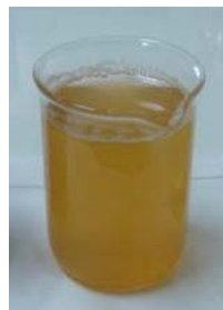
Lixiviado tratado físico-químico com coagulate tipo A - CF
