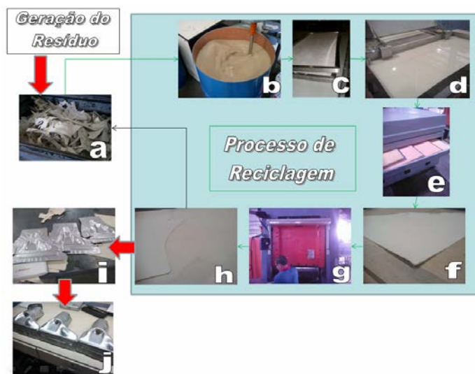
Figura 03: Esquema representativo do processo de reciclagem de isolantes térmicos. Em (a) a representação de aparas de resíduos de isolante térmico, em (b) o pulper, (c) as telas para a disposição das fibras, (d) caixa com água para a melhor ordenação das fibras, (e) forno de secagem das telas, (f) material obtido, (g) prensagem, (h) recorte do material e em (i) o material retorna para o processo produtivo, ou seja, para o preenchimento de defletores de calor (j).
