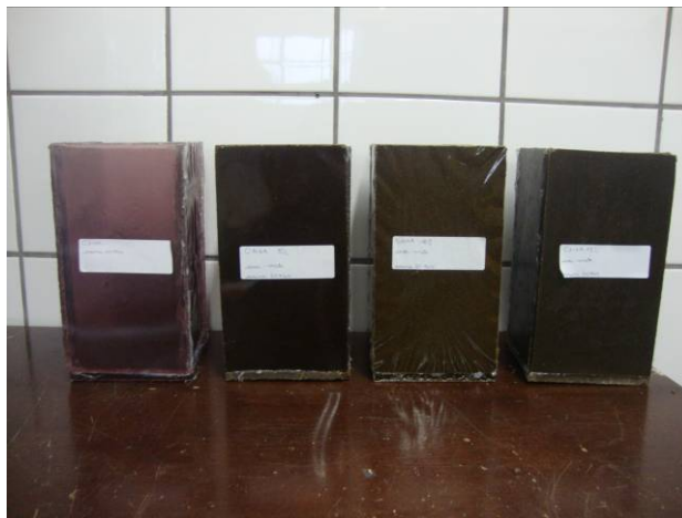
Figura 3 – Caixas elaboradas com a resina termofixa (100%) e com pó de erva mate (5%, 10% e 15% em massa).
