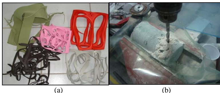
Figura 1: (a) Recortes de palmilhas de EVA e (b) resíduo de compósito epóxi/fibra de vidro gerado na fabricação de pá de aerogerador durante furação perpendicular (90°).
