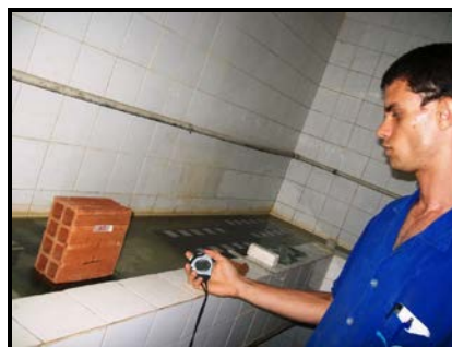
Figura 6 – Ensaio de absorção Inicial
