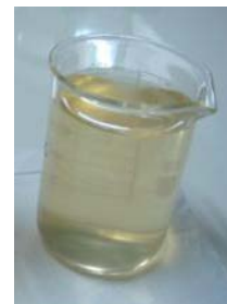
Lixiviado tratado físico-químico com coagulate tipo B - PAC
