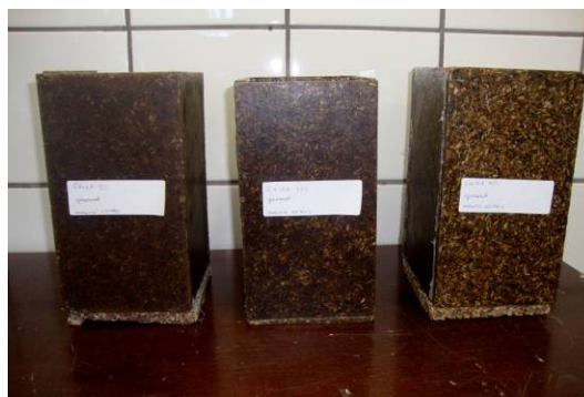
Figura 2 – Caixas elaboradas com de resíduo de girassol (5%, 10% e 15% em massa) e resina termofixa.
