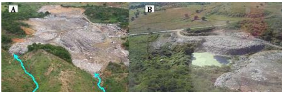
Figura 6: Imagens aéreas do lixão destacando o sentido da drenagem natural (a) e o acúmulo de lixiviado (b).
