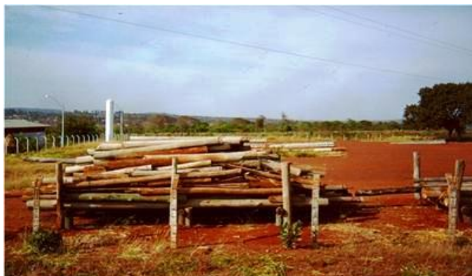
Figura 2 – Resíduos de madeira de eucalipto tratado retirado das Linhas de sub-transmissão.
