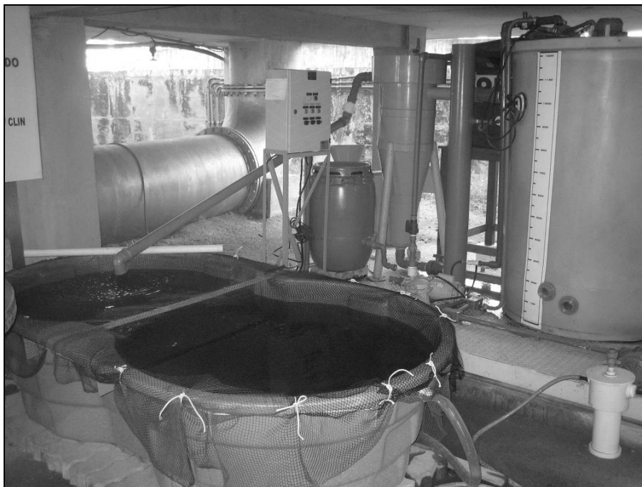
Figura 1 – Estação de tratamento piloto e aquário construído para os ensaios de toxicidade.
