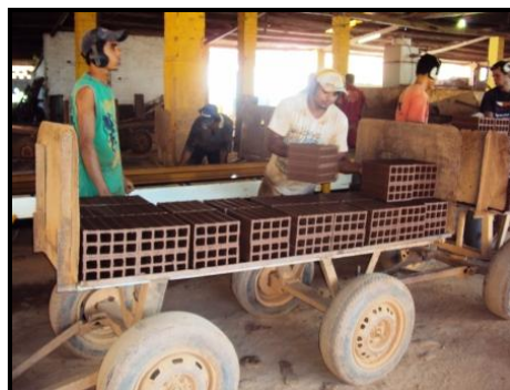
Figura 4 – Após a extrusão, os blocos são transportados para secagem de forma natural em galpão coberto
