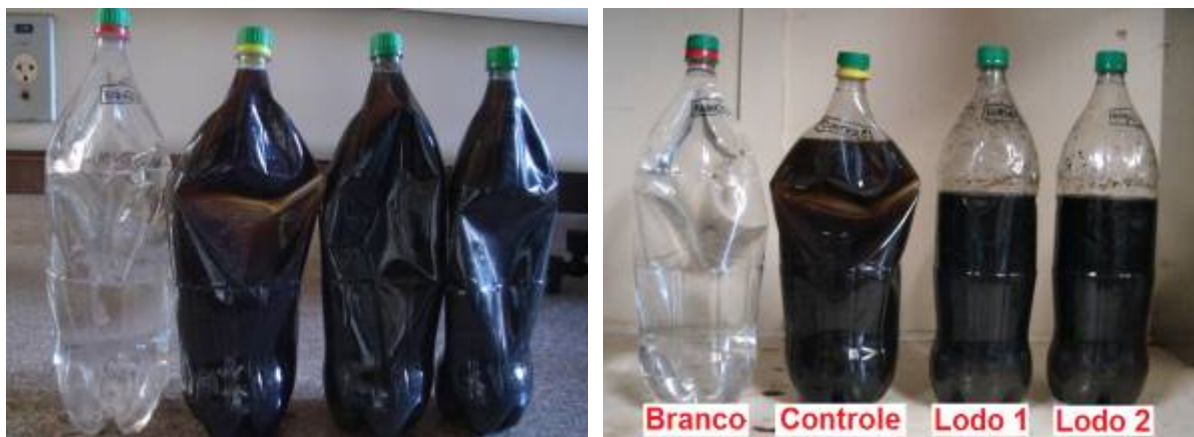
(a) (b) Figura 2: (a) Reatores do teste de atividade do lodo com headspace eliminado. (b) Reatores após 8 dias de experimento.
