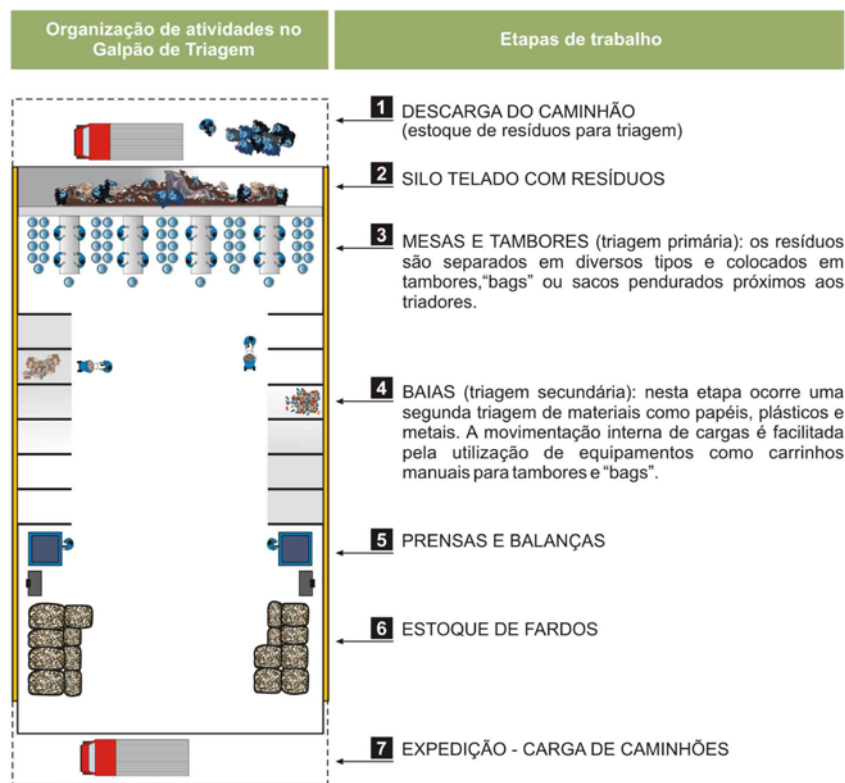
Figura 7. Esquema operacional de uma unidade de triagem.
