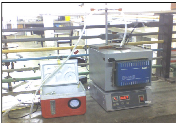
Figura 1 – Sistema completo de amostragem dos COVs.
