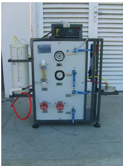
Figura 1. Foto do equipamento de MF/UF/NF de bancada.
