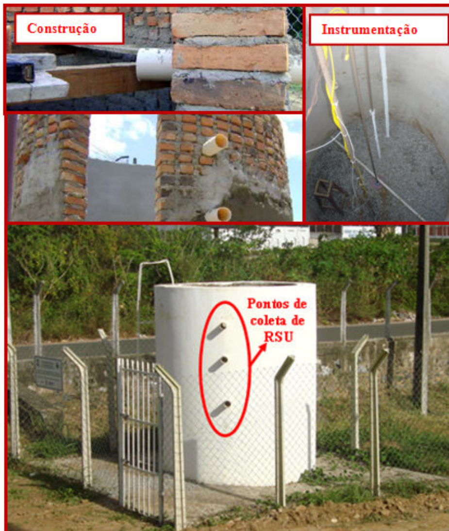
Figura 1: Construção, instrumentação e estrutura do lisímetro, localizado na UFCG.
