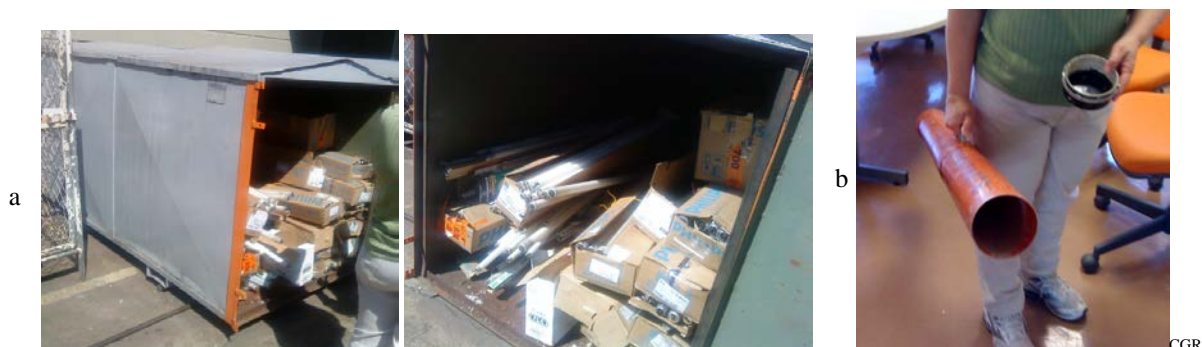
Figura 2. (a) Contêineres construídos em aço-carbono, de fabricação da empresa Apliquim (Paulínia, SP), dispostos a céu aberto, no pátio de empresa local e (b) Recipiente portátil, rígido e resistente, de PVC para transporte até o local de armazenamento definitivo.
