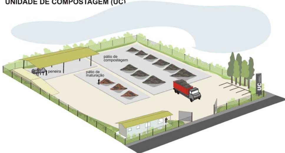
Figura 6. Esquema geral de uma unidade de compostagem.
