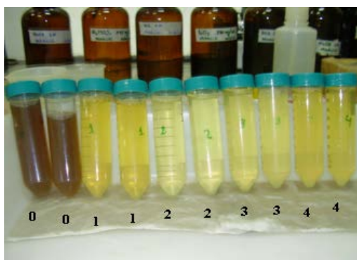
Figura 02: Alíquotas do licor sobrenadante após teste de coagulação, floculação e sedimentação nos jarros, usando como coagulante o sulfato de alumínio. (0 = 0 mg/L, 1 = 1175mg/L, 2 = 2350 mg/L, 3 = 3525mg/L e 4 = 4700 mg/L do coagulante sulfato de alumínio).
