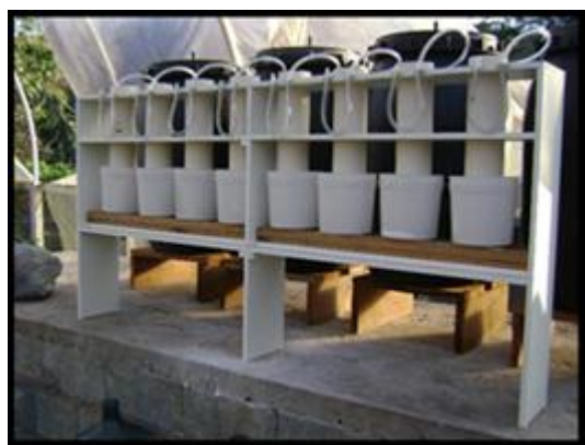
Figura 3. Estrutura dos 8 gasômetros em coluna de óleo de cozinha. (a) vista completa. (b) vista detalhada dos tubos em U.
