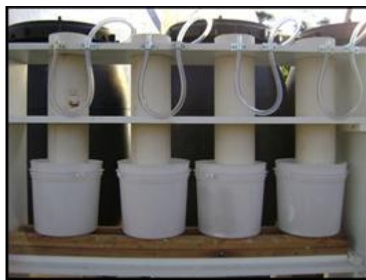
Figura 3. Estrutura dos 8 gasômetros em coluna de óleo de cozinha. (a) vista completa. (b) vista detalhada dos tubos em U.
