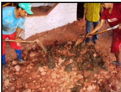
Figura 2 - Lodo sendo misturado à massa cerâmica
