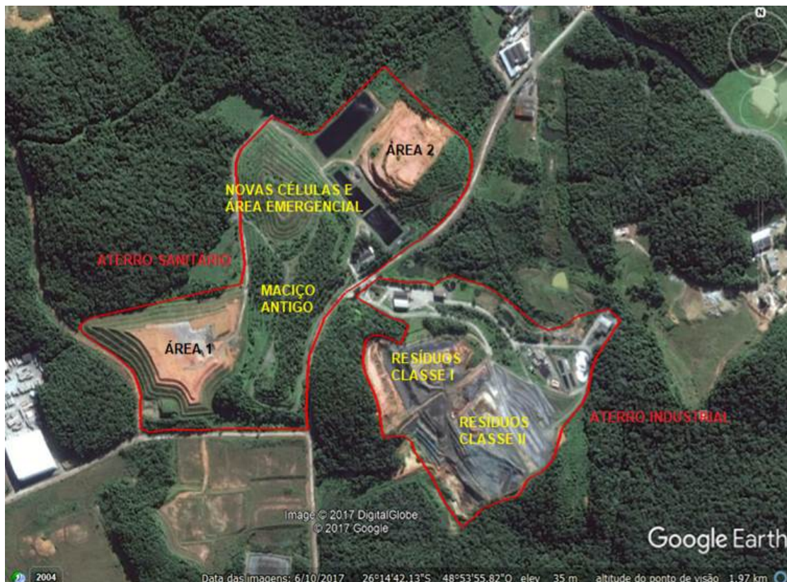
Figura 3 – Divisão das células dos aterros
