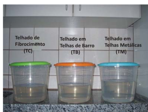
Figura 5 – Amostras de água de chuva coletadas das coberturas durante a segunda chuva.
