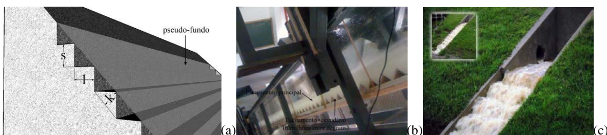
Figura 1: (a): Definição da altura de rugosidade. (b): skimming flow , em modelo físico do Laboratório de hidráulica Ambiental – EESC-USP (Simões, 2012). (c): nappe flow em um dos canais em degraus do sistema de drenagem da USP/SC, Campus II.
