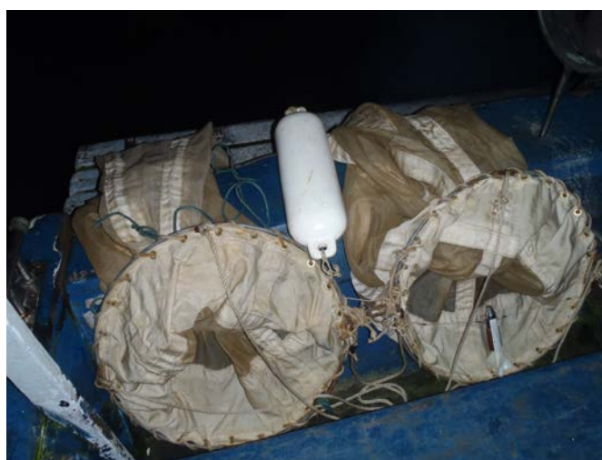
Figura 2: Rede bongô com malha de 200 \mu m, com fluxômetro acoplado, utilizada na coleta das apendiculárias.
