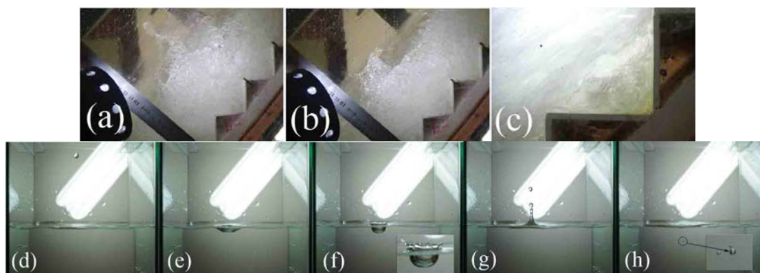
Figura 2: Fenômenos relacionados à entrada de ar na água (Laboratório de Hidráulica – EESC/USP): (a e b) Deformação da superfície livre - Imagens obtidas com estroboscópio. (c): Turbilhão bifásico (ar-água). (d a h) Incorporação de uma bolha de ar após a entrada de uma gota de água em um volume em repouso. Fonte: Simões (2012).
