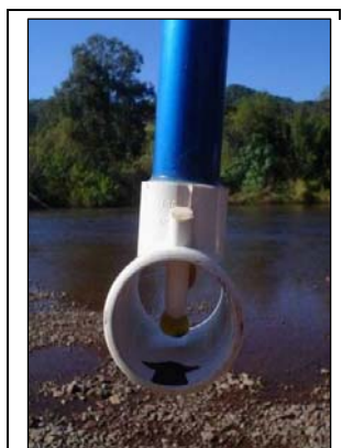
Figura 5 – Detalhe da hélice de medição de vazão.
