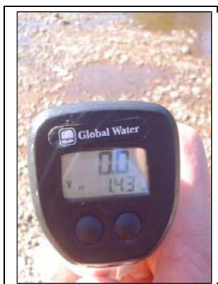
Figura 4 – velocímetro no medição de vazão.
