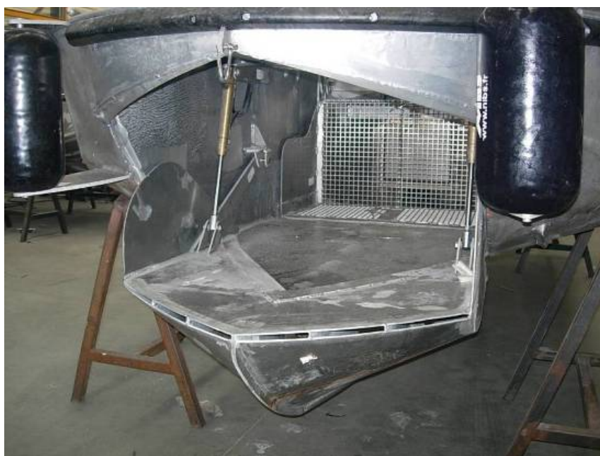
Figura 3 - Casco aberto para retenção de resíduos
