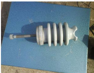
Figura 1. Isolador cerâmico tipo poste, classe de tensão 15 KV, com ferragem metálica.
