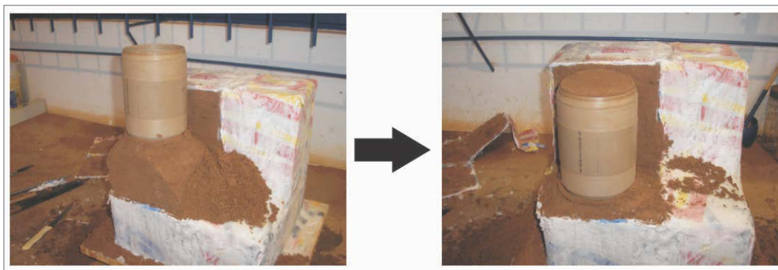
Figura 5: Moldagem de corpo de prova no permeâmetro de PVC
