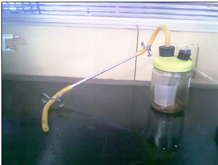
Figura 2 – Respirômetro alternativo utilizado nos experimentos – Detalhe do filtro com cal sodada para remoção de CO 2 do ar
