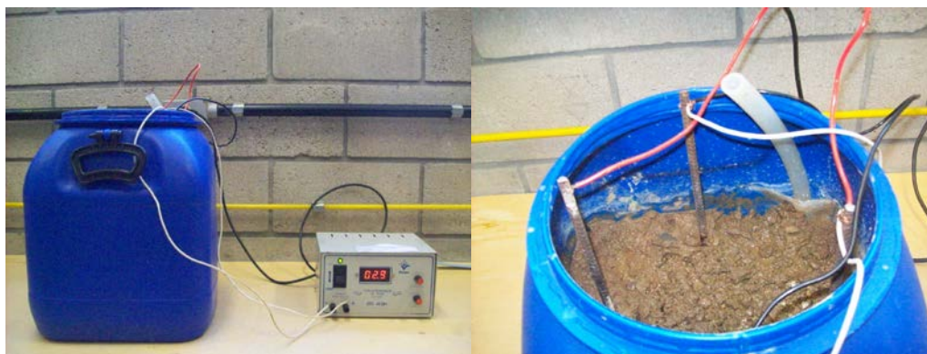
Figura 01 a e b: Montagem do sistema de eletro-biorremediação.
