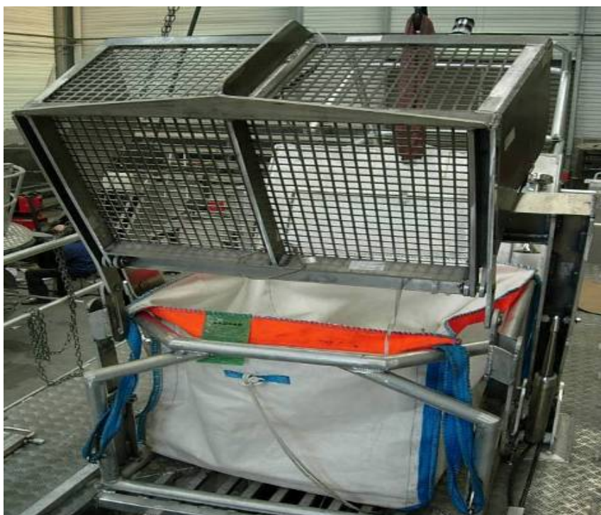
Figura 4 – Cesto de retenção de resíduos e “Bag” para armazenamento dos resíduos sólidos coletados
