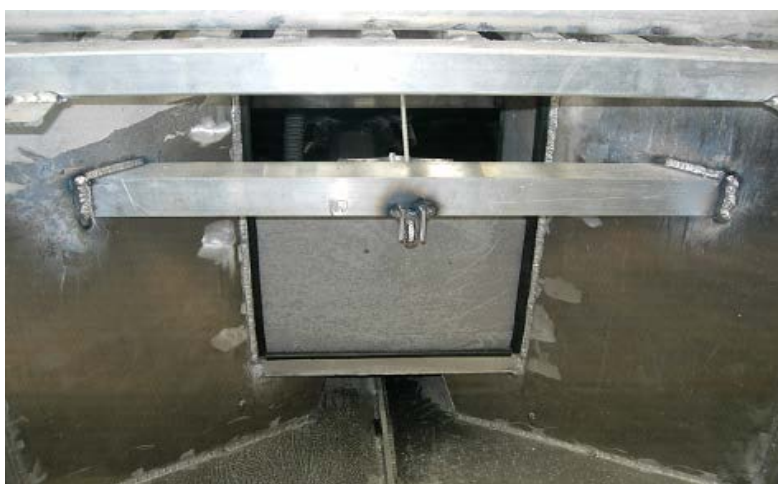
Figura 5 – Skimmer fechado para retenção dos hidrocarbonetos.
