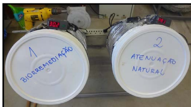
Figura 2: Início do processo de remediação; Biorremediação (Reator 1) – Atenuação Natural (Reator 2).
