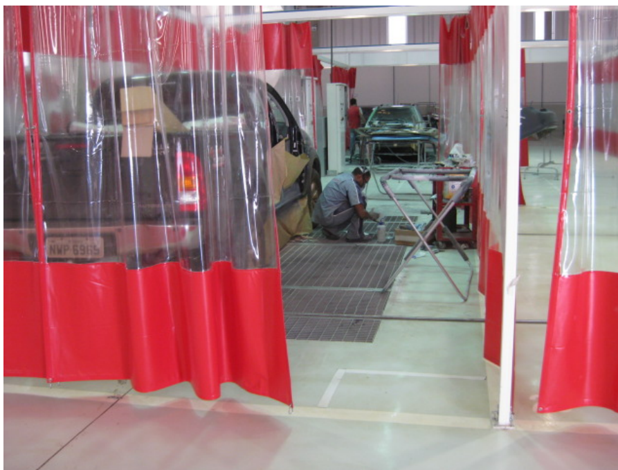
Figura 8: Serviço sendo realizado sobre o plano aspirante, Concessionária de veículos, Aparecida de Goiânia, GO.
