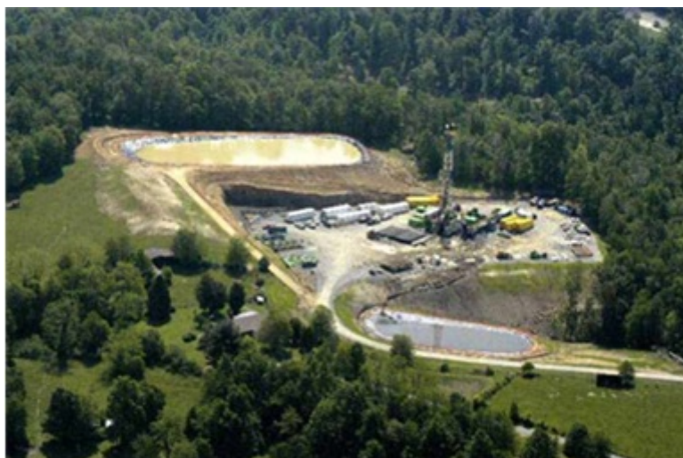
Figura 3 - Foto de piscinas de flowback e água de produção - fonte: http://www.iee.usp.br/eventos/nov12/Colombo_Shale.pdf
