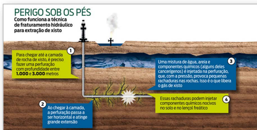
Figura 1- Funcionamento da Técnica do Fracking –
