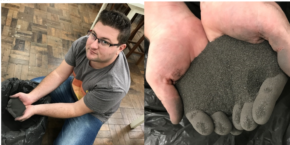
Figura 1. Separação de amostras para os testes de lixiviação e solubilização da areia de moldagem descartada
