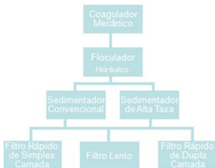
Figura 02 – Fluxograma da ETA
