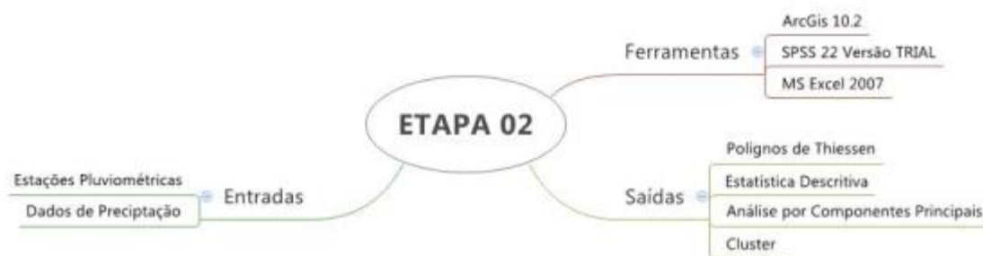
Figura 2. Fluxo de entradas, ferramentas e saídas para o processamento dos dados das estações pluviométricas da Unidade Hidrográfica do Paranoá.
