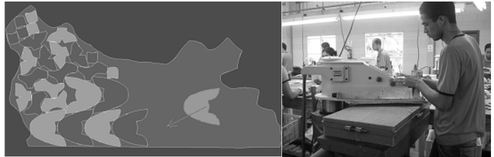
Figura 4 - Modelos de posicionamento de navalhas na pele (Fonte: empresa estudada) a) automatizado por computador b) manual no balancim ponte
